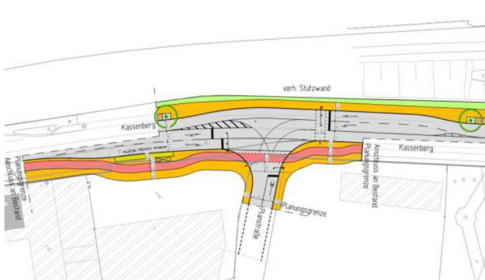
Abb. 5.2.1-2 Entwurfsskizze für den Knotenumbau zur Erschließung des Lindgensareals an der B223 (eigene Darstellung)
