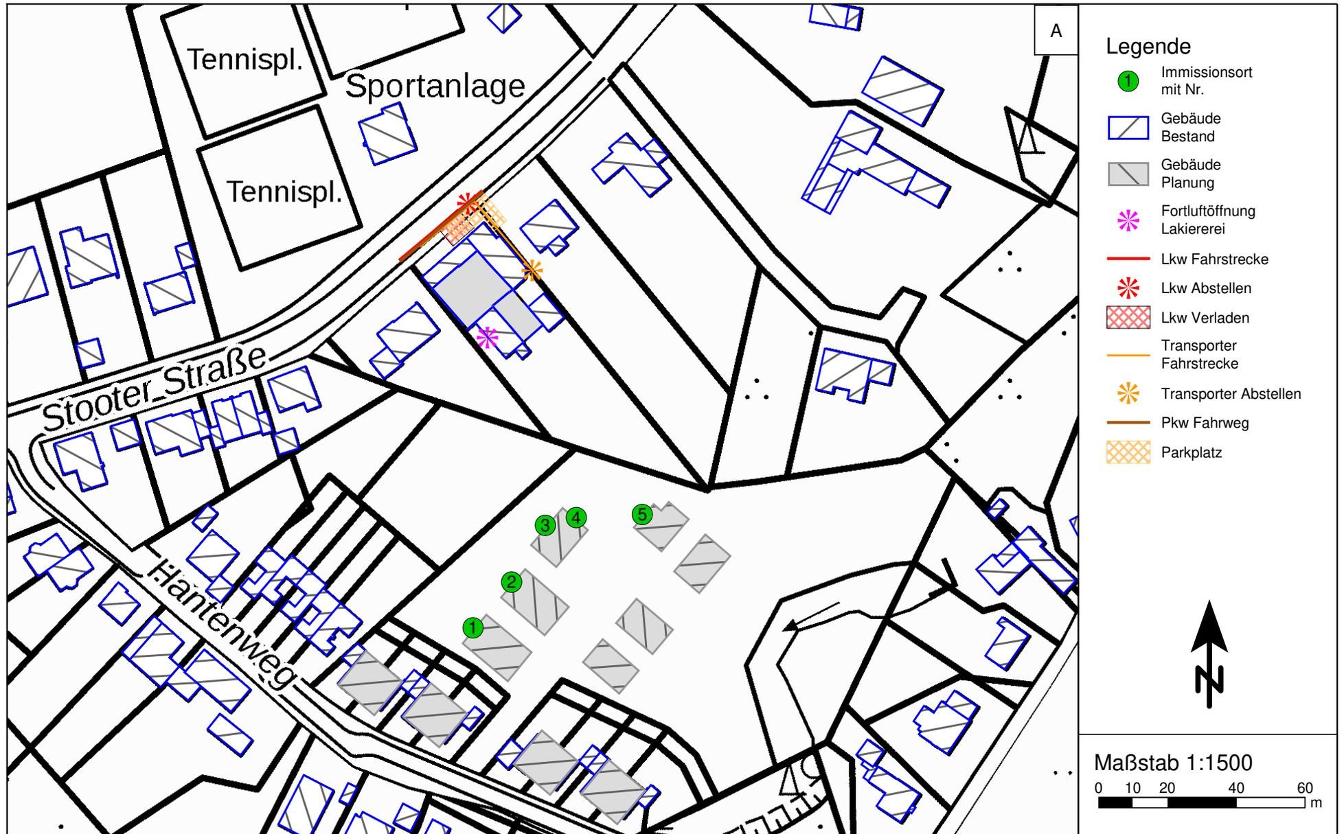
Darstellung des digitalen Simulationsmodells mit Kennzeichnung der berücksichtigten Immissionsorte hinsichtlich Sportlärm
