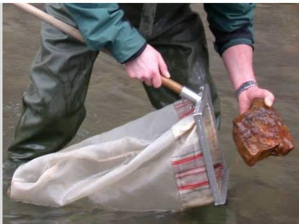
Foto 5: Probenahme unter Verwendung eines Shovel-Samplers
