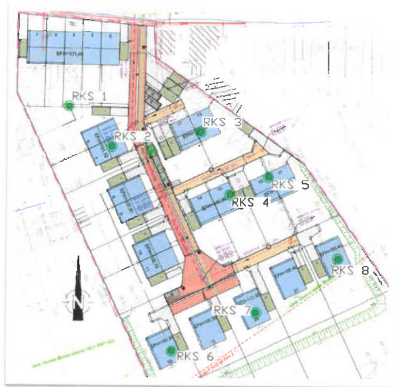
Abbildung 2: Lageplan mit Eintragung der Ansatzstellen der durchgeführten Rammkernsondierungen vom 07.03.2017
