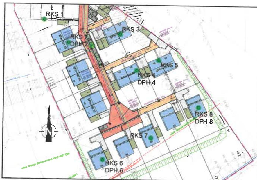
Abbildung 7: Lageplan mit Eintragung der Ansatzstellen der durchgeführten Rammkernsondierungen vom 07.03.2017
