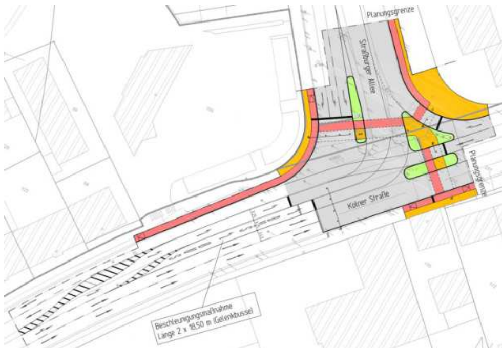
Abb. 5.2.1-5 Errichtung einer zweiten Linksabbiegerspur auf der Kölner Straße in Richtung B223 für Busse der Linien 133 und 752 (eigene Darstellung)
