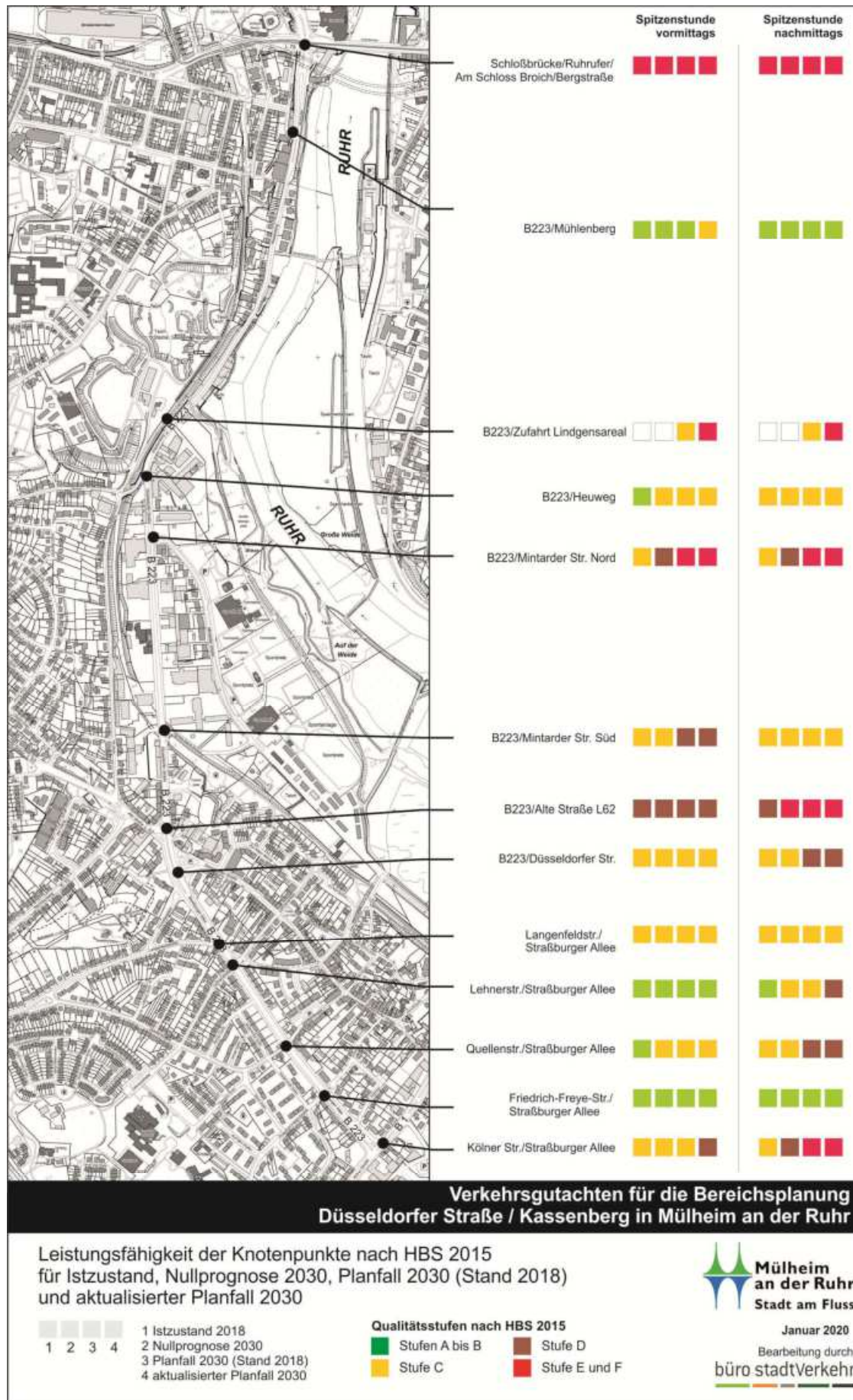
Abb. 4.2.1-1 Qualitätsstufen der Knotenpunkte entlang der B223 für den Istzustand, Nullprognose, Planfall 2030 (Stand 2018) und aktualisierter Planfall 20030
