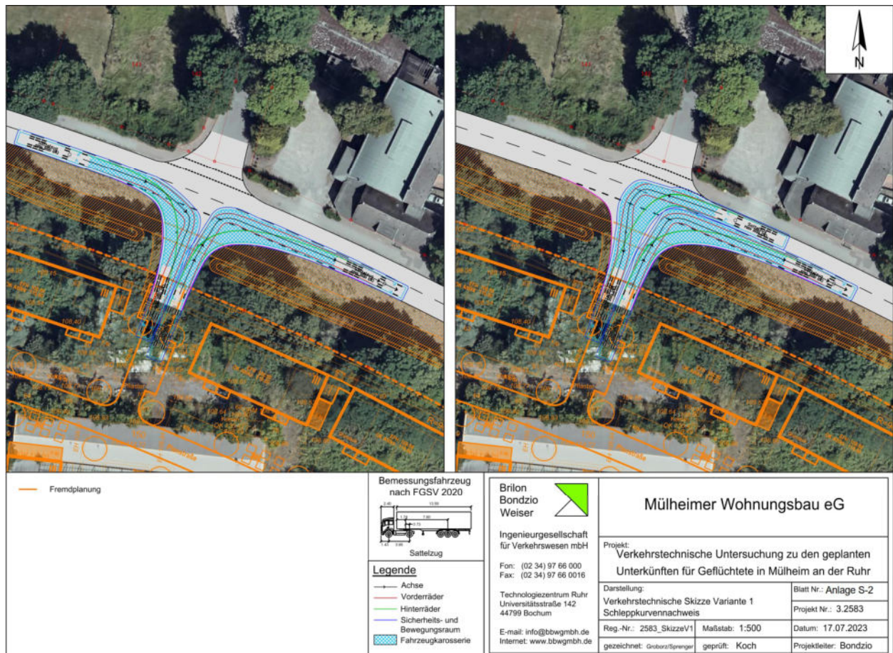
Abbildung 4: Verkehrstechnische Skizze der Schleppkurvenprüfung an dem geplanten Anbindungspunkt des Vorhabens im Analyse-Plusfall Baustellenverkehr [Kartengrundlage: Digitale Orthophotos, Geobasis NRW 2023 (dl-de/by-2-0)]
